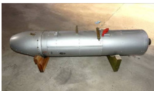
Podvesný raketový blok R 57-4M pre lietadlo Aero L-29 Delfín, 1960..1970; výrobca Aero Vodochody; zbierka Letectvo a letecká technika; výskum, vlastný zber.
