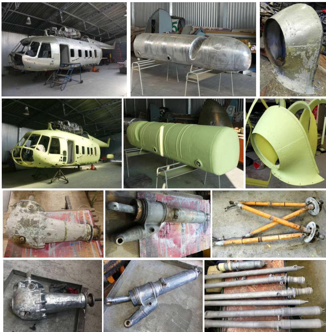
Vrtuľník Mi-8 PS-9 e. č. 2839; reštaurovanie: očistenie trupu, krytov, reduktora
