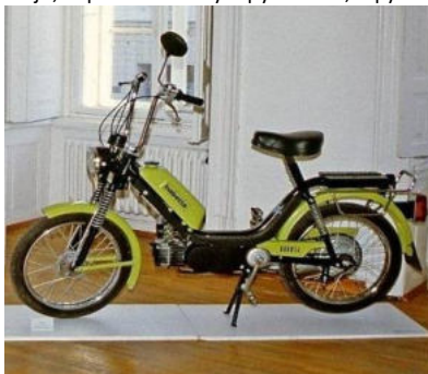
Moped Babetta, typ 210 automatic, autor dizajnu J. Šafarik, motor s 2-st. prevodovkou - patent Považské strojárne ZVI Považská Bystrica, výroba od r. 1986; zbierka Strojárstvo; spôsob nadobudnutia: kúpa.
