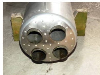
Podvesný raketový blok R 57-4M pre lietadlo Aero L-29 Delfín, 1960..1970; výrobca Aero Vodochody; zbierka Letectvo a letecká technika; výskum, vlastný zber.
